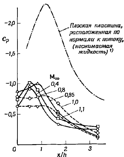
Ф и г. 14. Статическое давление на центральной линии следа [13].
